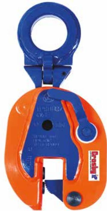
Die Schiffbauklemmen IPSBU(U)Z eignen sich für das Heben, Transporten und Positionieren kompletter Schiffsteile. Diese Klemmen verfügen über eine Verriegelung in geöffneter und geschlossener Stellung, die für höchste Zuverlässigkeit sorgt. Sie eignen sich ausschließlich für Wulstprofile nicht für Platten.
